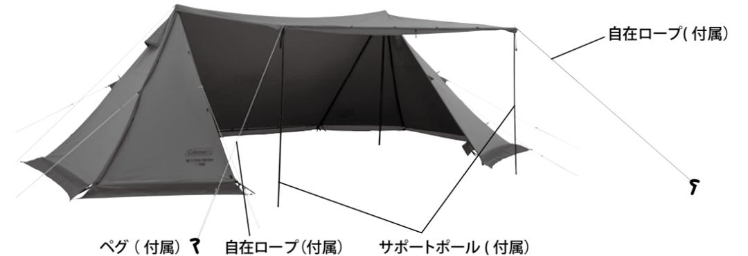
**注意** 雨天時にシェードスキンを張り上げる際は、水がたまりやすくなりますので、傾斜を作るか、中央部にロープを結びペグ止めて雨水を流してください。
